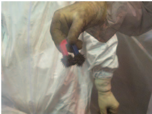
図-3.4.5 磁石による鉄粉の混入確認
