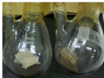
(図 4) 蒸気浸透法により(左)結晶化度 60%、(右)同 10% のポリエチレン試料に TEMPO を添加した様子。
