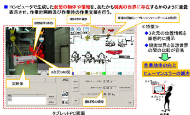
写真2 解体作業シミュレーションの一例 2)
