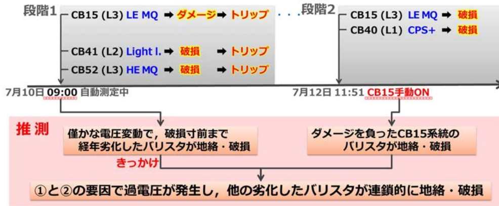
Fig. 4. バリスタ破損の時系列とシナリオ。①と②の要因については本文及び Table 1 に示す。LE MQ と HE MQ は、それぞれ Low Energy Magnetic Quadrupole (LE MQ) Interface と High Energy Magnetic Quadrupole (HE MQ) Interface を表す。また Light l.は Light link を表す。L1, L2, L3 は 3 相交流の相順を示す。
