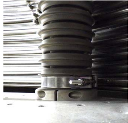
図 4b. ホースクランプによる補強
