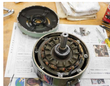
Fig.9 故障した発電機のベアリング
