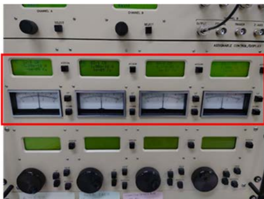
図 4. アサインブルコントローラーの アナログメーター 赤で囲んだ部分が M1 から M4
