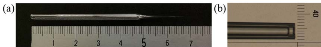
Fig. 1: (a)ガラスキャピラリー光学系、(b)キャピラリー先端 (出口径 50 μm)
