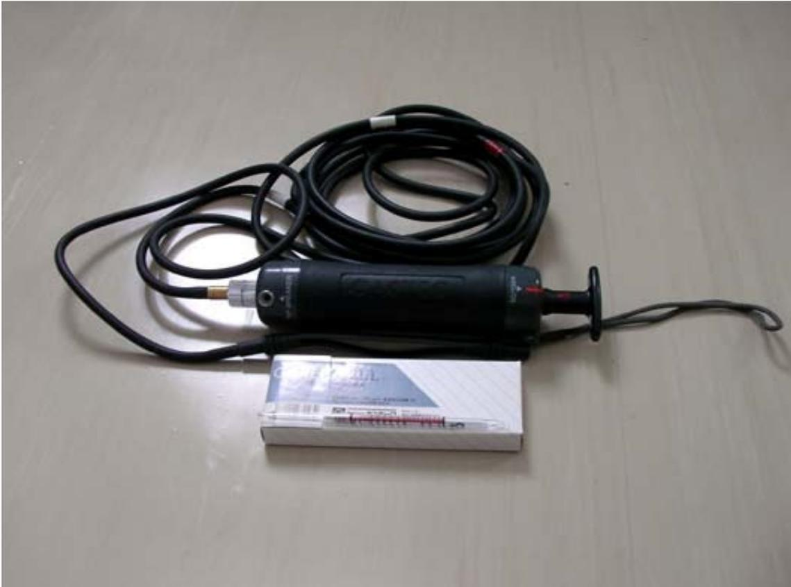
図 2-2 気体採取器 GV-100 と検出管
