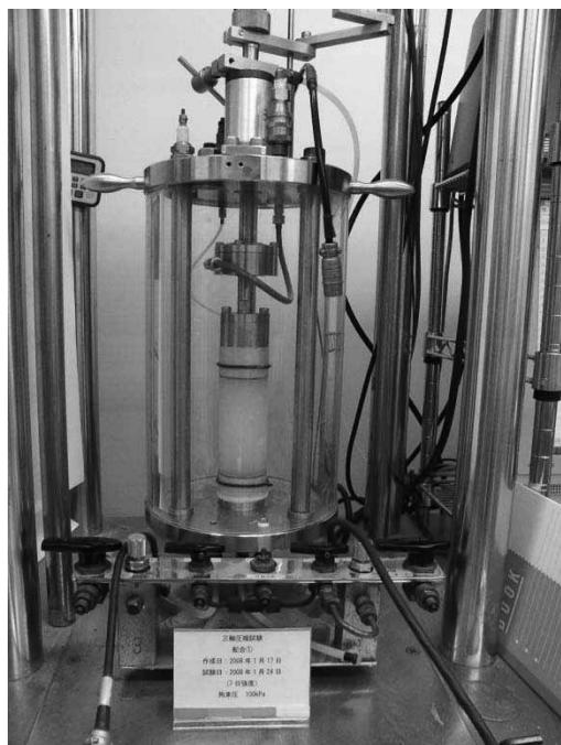
写真 2.3-6 三軸圧縮試験の載荷状況（2007 年度，配合 1，材齢 7 日，拘束圧 100kPa 時）
