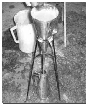
写真 2.2-2 P漏斗流下試験
