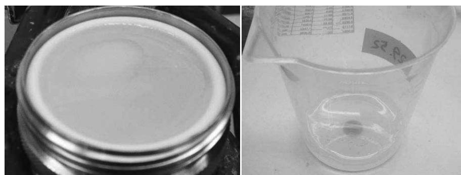
写真 2.3-14 超微粒子セメント透過後の状況（左）と透過したスラリー（右）
