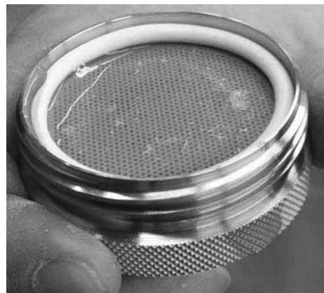
写真 2.3-13 溶液型（配合番号4）の透過後にできた堆積物
