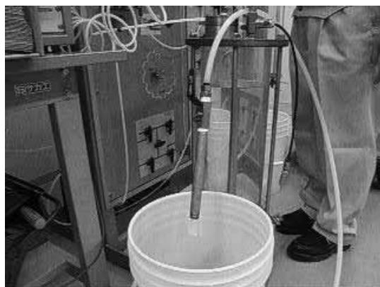
写真 2.3-16 パイプ押出し試験によるグラウト材料の抜け出し（2007 年度）
