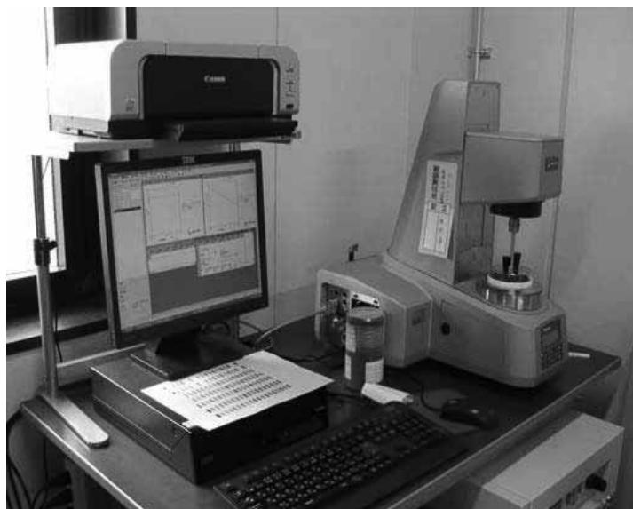
写真 2.3-3 Anton Paar 社製レオメータ Physica MCR301
