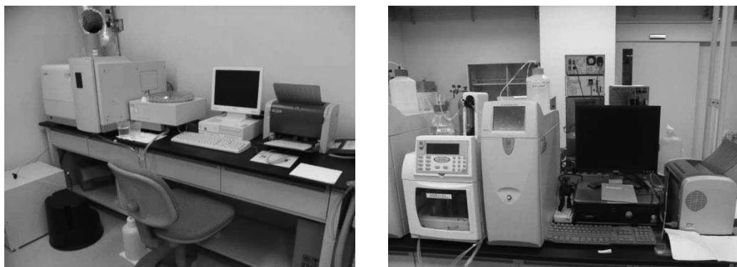
(左；ICP 発光分光分析装置(SPS7800), 右；イオンクロマトグラフィーシステム(ICS3000))
