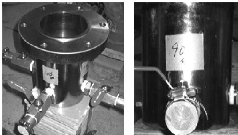
写真 2.2-3 鋼製メッシュ透過試験装置
