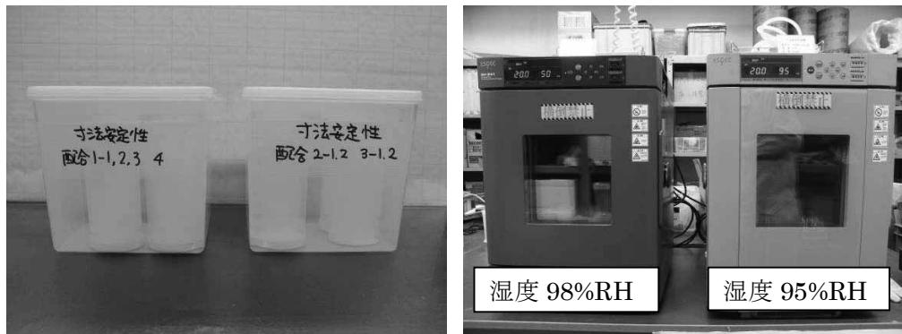
写真 2.3-2 寸法安定性試験の養生状態（左；水中養生，右；恒温恒湿槽）
