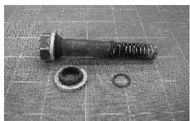
写真 2.2-11 ボルト、止水ワッシャー、O リング
