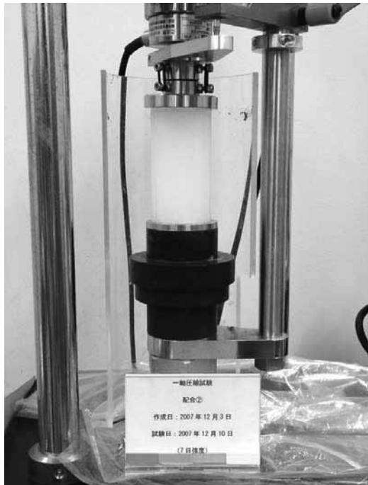
写真 2.3-1 一軸圧縮試験の載荷状況（2007 年度，配合 2，材齢 7 日）
