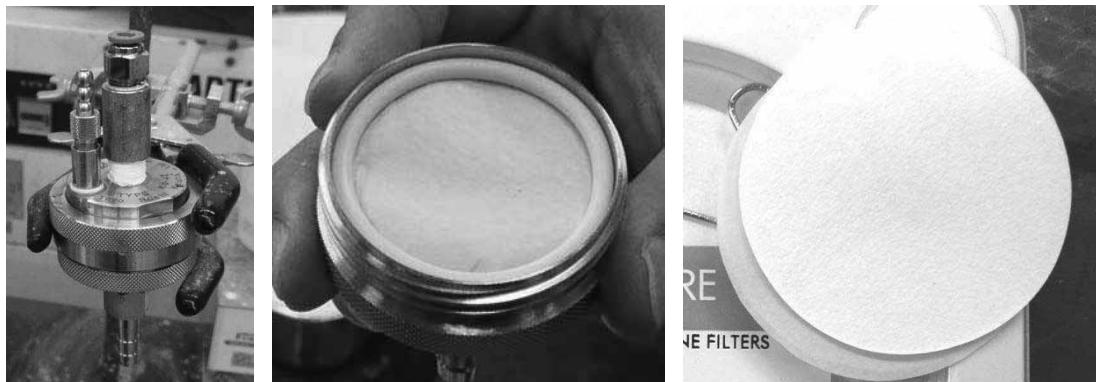
写真 2.3-5 ろ過試験装置とろ過フィルター（見開き量 10μm）
