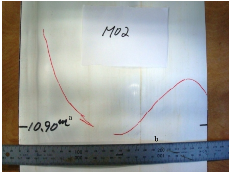
図 4.50 M02 孔の深度 10.9m におけるき裂の型取り結果
