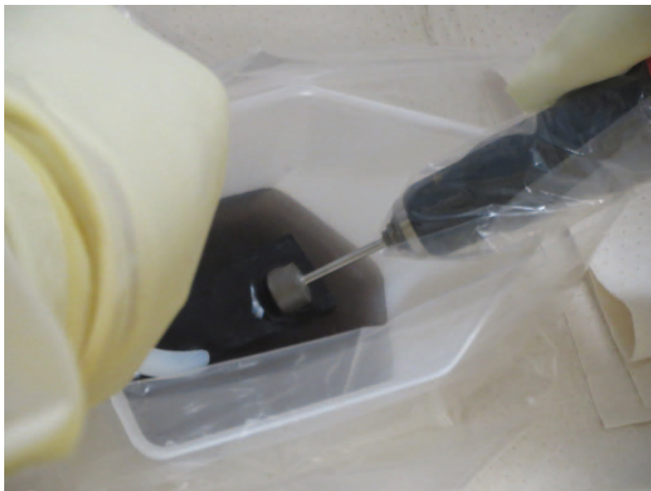
マイクログラインダーによる研磨の様子(純水中で研磨)
