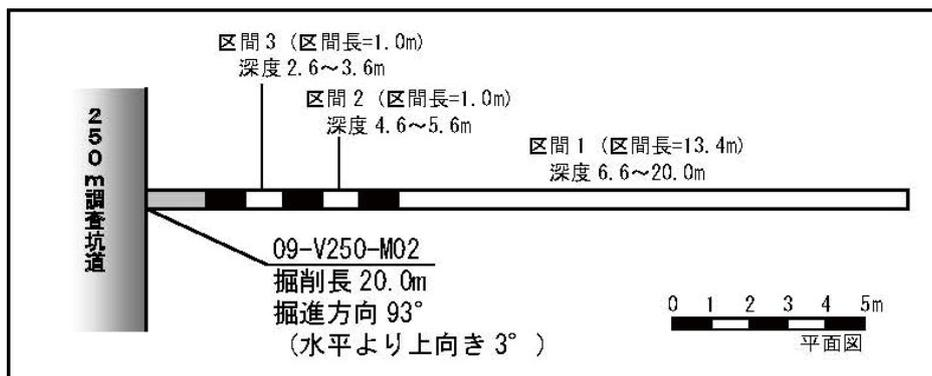
図 2.1-5 09-V250-M02 孔における観測区間の詳細図
