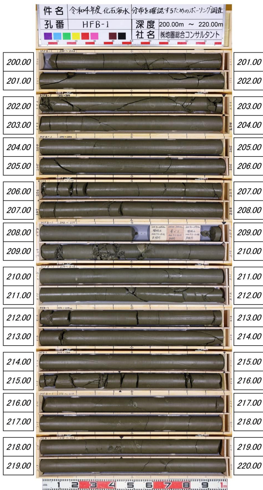
Fig. 19 接合した岩芯写真の一例（深度 200.00 m～220.00 m）
