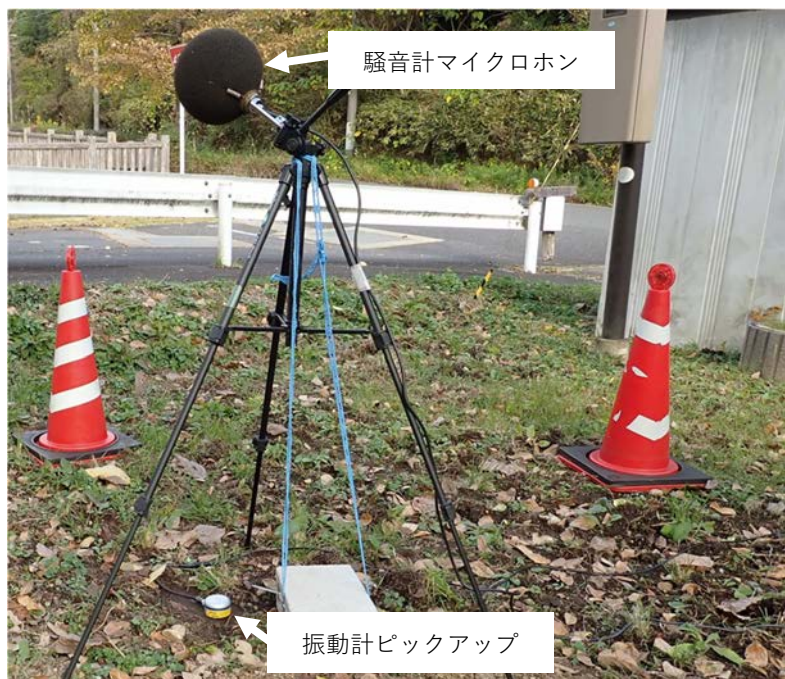
図3.4.1-2 騒音測定・振動測定の測定機器設置状況
