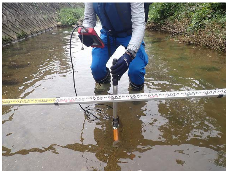
図3.2.1-4 流速測定状況
