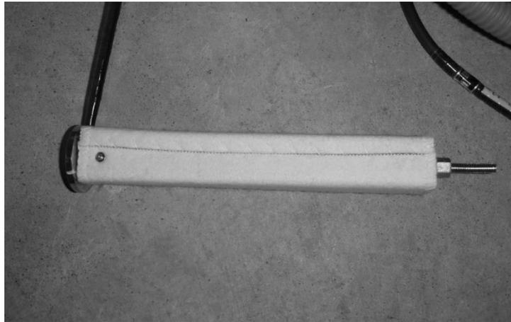
図 2-11 コンクリート有効応力計 (GK-ON-505, 東横エルメス)
