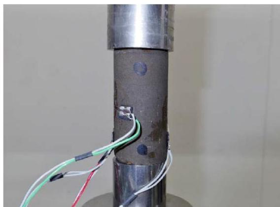
図 2-25 一軸圧縮試験状況
