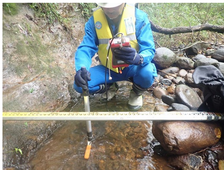
図3.2.1-3 流速測定状況
