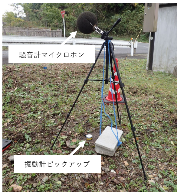
図3.4.1-2 騒音測定・振動測定の測定機器設置状況
