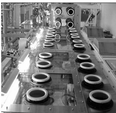
CPFに設置した電解精製及び陰極処理などからなる試験設備を用いてU試験を実施、高いU回収率(>96%)を確認。
