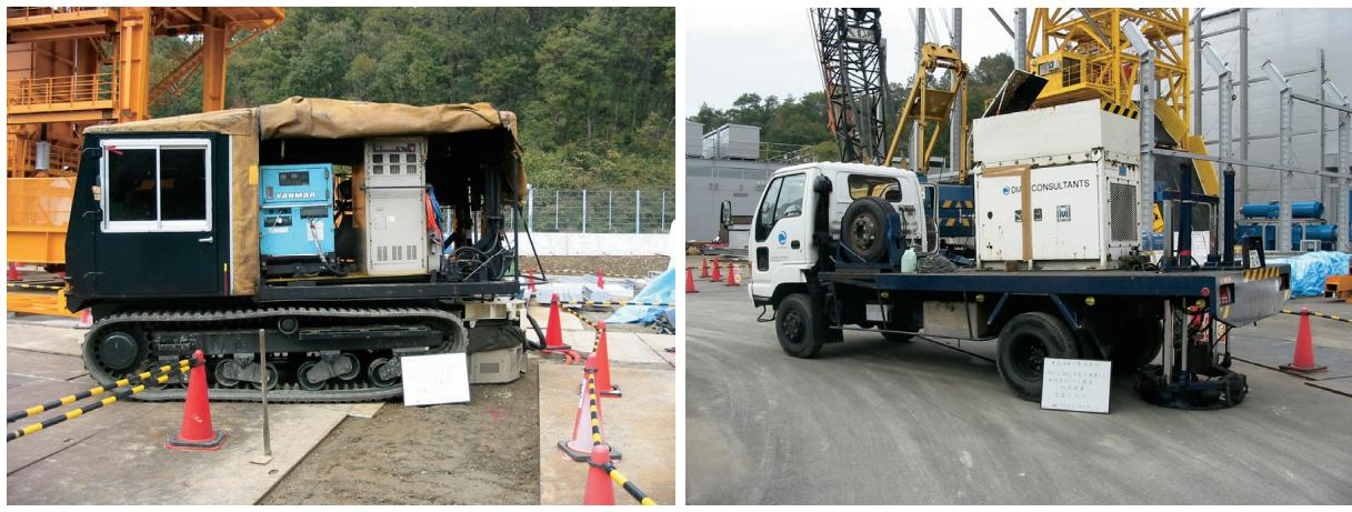
図 20 地表発振一孔内受振の弾性波トモグラフィ探査において使用した震源装置
