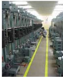
クリープ試験装置<br>・高温強度と靱性を併せ持つ材料の開発・試験<br>・試作材に続き商用材(商業生産用設備で製作)を製作し、長時間クリープ試験(5万時間)、クリープ疲労試験等を実施<br>・種々の条件で製作した溶接継手(異材溶接継手を含む)に対する試験を行い、その結果に基づき、溶接材料、溶接方法、熱処理条件等の最適化を図る |
