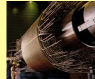
FBR熱交換器伝熱管 (1インチ径、100m長さ)
