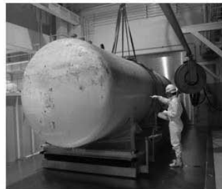
タンクの汚染検査
