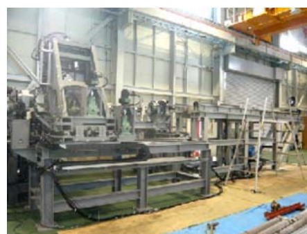
図7 解体システム試験装置
