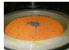
浅皿容器による脱硝体(240gU)
