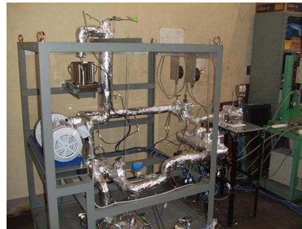
噴流型壊食試験装置
