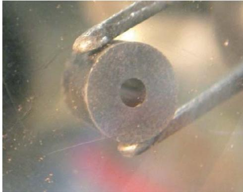
図 3.3-7 焼結した中空ペレット(MOX)
