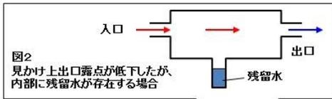
図2 見かけ上出口露点が低下したが、内部に残留水が存在する場合
