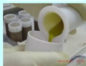
■ 酸浸漬法による溶解残さの再溶解
