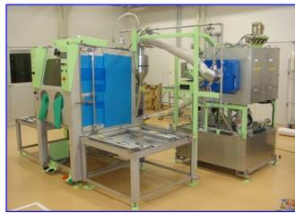
手動除染装置を製作及びタービン解体跡地に設置 (H22年度)
