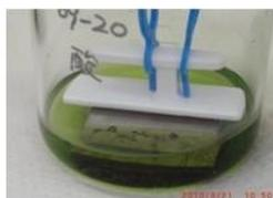
金属試料の酸浸漬の様子
