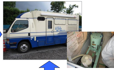
プール水の採取後、移動式ゲルマ検出器で放射能計測
