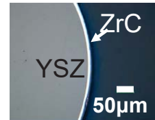
ZrC被覆粒子の断面
