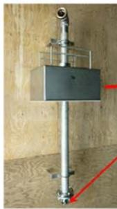
製作した散水装置
