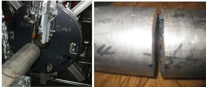
隔離冷却系熱交換器の入口配管の一次切断にレーザーを適用
