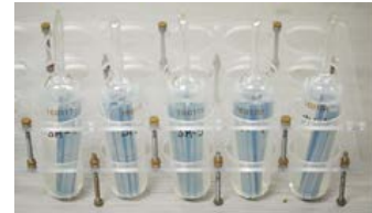
図1 アンブルを用いたガス発生試験
