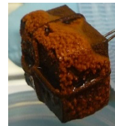
図3 錆が付着した炭素鋼
