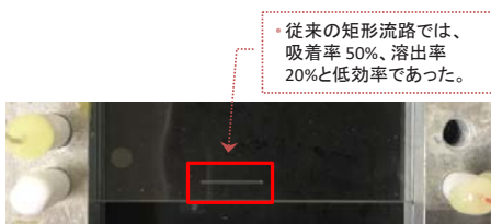
図1 従来のマイクロチップ (流路は幅: 1 mm、深さ: 20 μm、長さ: 8 mm の矩形)
