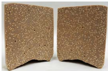
図1 ジオポリマー固化体の断面 (ゼオライト粒子を20wt%含有)
