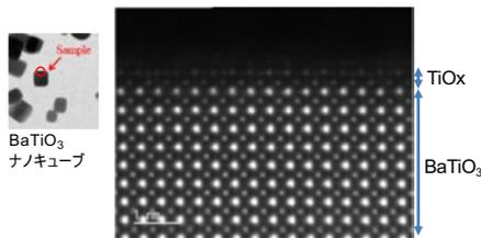
$\text{BaTiO}_3$ 粒子表面の電子顕微鏡観察により、最表面は2層のTiカラムで覆われていることが分かった。
