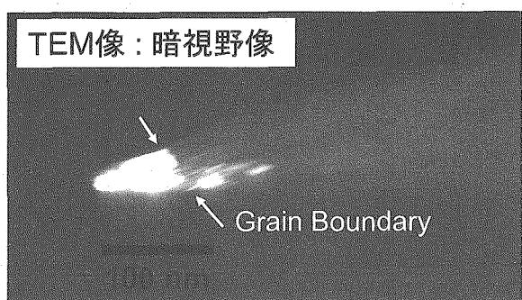
Fig.14 シュラウド材・粒界近傍から作製した針状試料の TEM 像（暗視野像）
