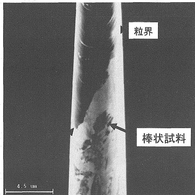
Fig.5 棒状試料において 2 つの結晶粒が存在する箇所の二次電子像
