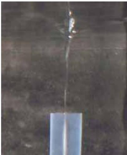
図 A3.1-1 出口配管位置に達するガスコア深さの伸長例 1 ( Okamoto<sup>(A3.1-1)</sup> )
