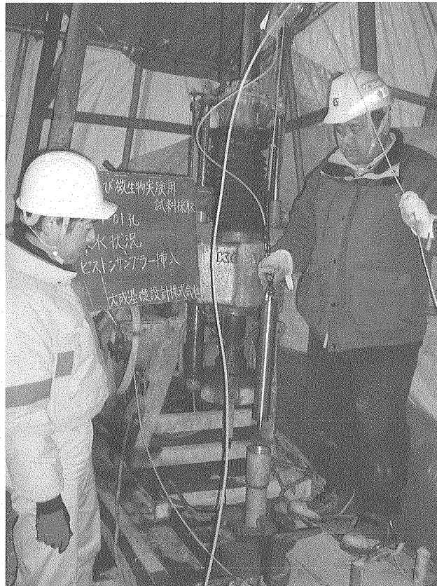
図 2.1.1-8 ピストン式サンプラーによる地下水の採水
