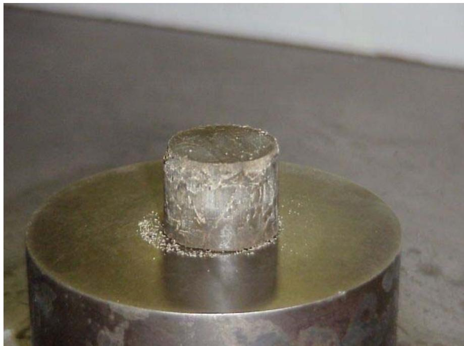
(f) 押し込み試験（手順2～3）終了後の試験片
