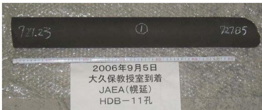
図2-4 稚内層硬質頁岩のコアの写真（HDB-11孔）
