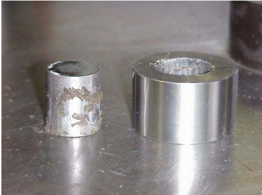
(e) 押し込み試験（手順2～3）終了後の押し棒と構成厚肉円筒
