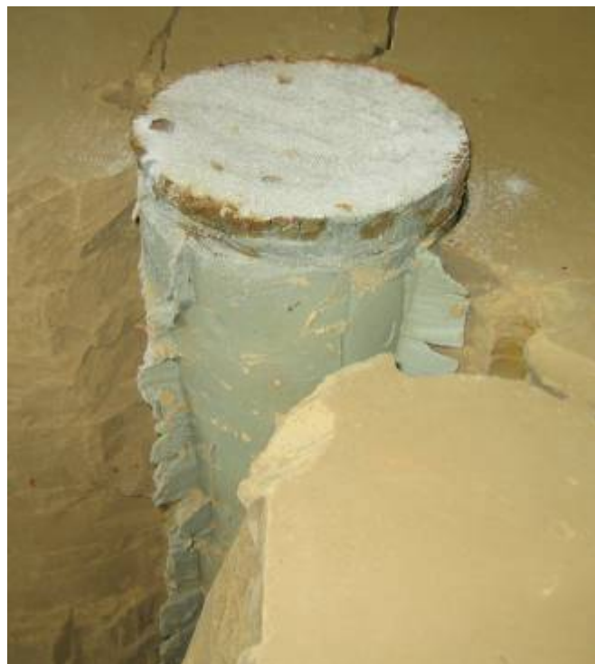
図 4-2 引張破壊による放射状の破壊形状
