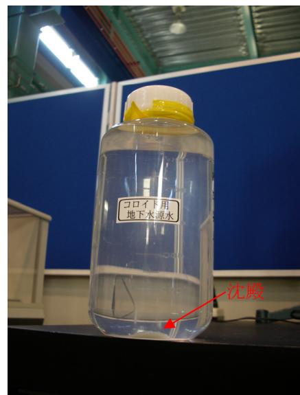
写真 2.4 沈殿が生じた地下水試料の状況
