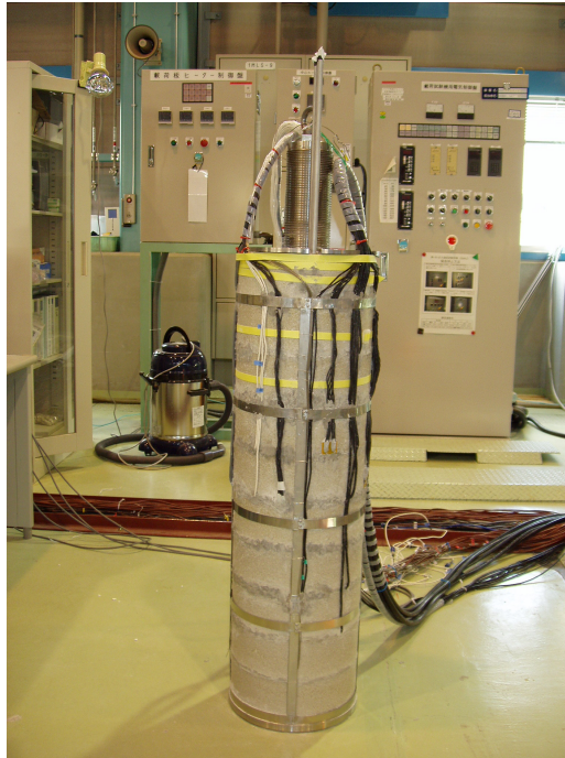
写真 2-1 緩衝材試験体セット完了状況
