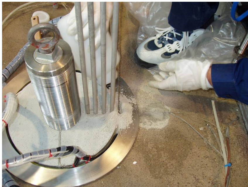
写真 2-2 緩衝材 - 模擬岩体隙間充填状況
