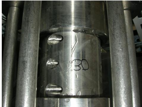
図 4.4-8 スリット継ぎ目部からの漏水状況
