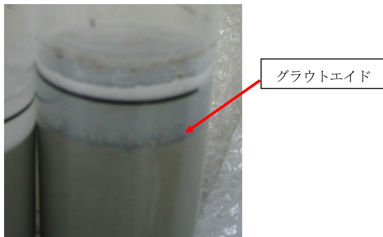
図 3.2-30 GA10PC15N の上澄み液 (上澄み液にグラウトエイドが浮いている状態)
