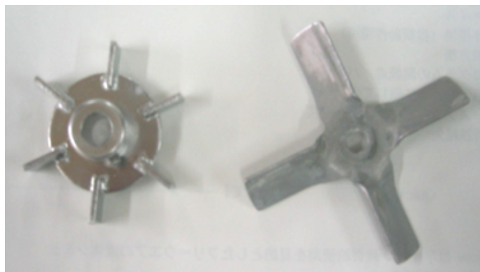
図 4.2-3 攪拌翼（左側：φ50mmフラットタービン翼、右図：φ68mmピッチドパドル翼）
