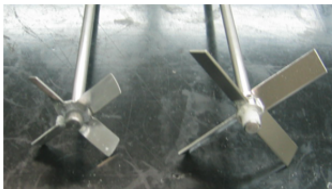
図 3.2-8 使用する攪拌翼（ピッチドパドル翼） （左側：φ68mm、右側：φ100mm）
