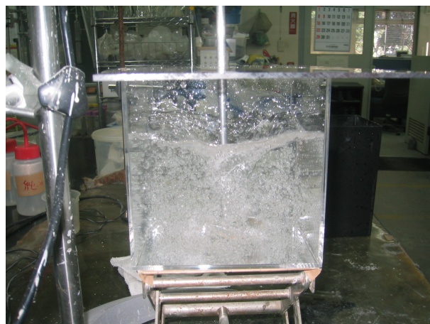
図 3.2-35 邪魔板及び攪拌槽による攪拌力の影響
