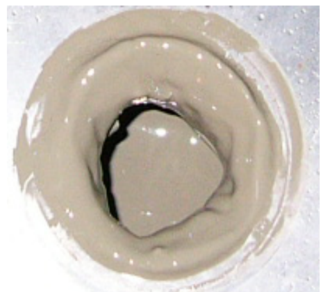
図 5.4-13 F-10-16、スリット開口幅 100\mu\text{m} (1回目) の試験結果 (左図：単位時間当りの通過流量、右図：フィルターケーキの状況)
