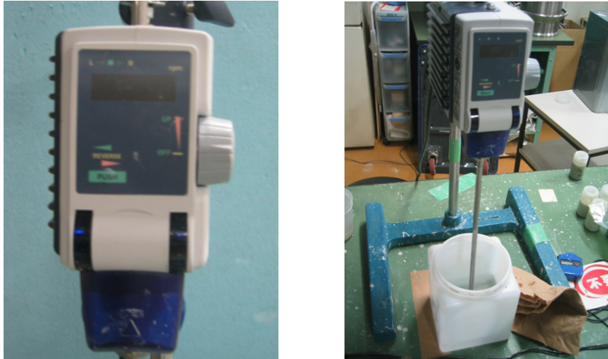
図 4.2-2 攪拌装置と攪拌状況
