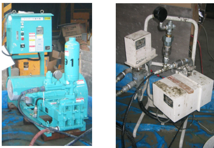
図 5.3-7 試験に使用したグラウト装置 (左図：グラウトポンプ、右図：電磁流量計)
