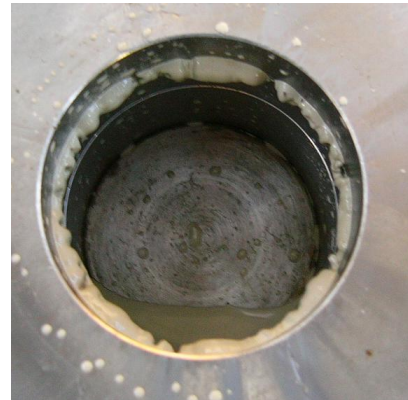
図 5.4-15 U-00-20N、スリット開口幅 75 \mu\text{m} の試験結果 (左図：単位時間当りの通過流量、右図：フィルターケーキの状況)
