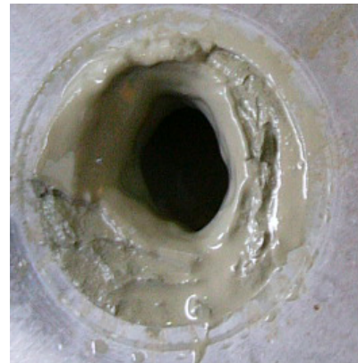
図 5.4-9 F-00-10、スリット開口幅 75 \mu\text{m} の試験結果 (左図：単位時間当りの通過流量、右図：フィルターケーキの状況)
