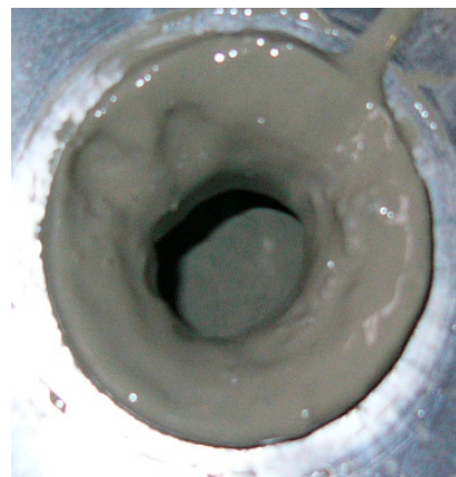
図 5.4-10 F-10-10、スリット開口幅 150 \mu\text{m} の試験結果 (左図：単位時間当りの通過流量、右図：フィルターケーキの状況)
