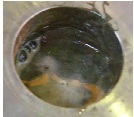
図 5.4-17 R-00-16M、スリット開口幅 150 \mu m の試験結果 (左図：単位時間当りの通過流量、右図：フィルターケーキの状況)
