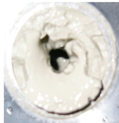
図 5.4-19 U-00-20、スリット開口幅 150 \mu m の試験結果 (左図：単位時間当りの通過流量、右図：フィルターケーキの状況)
