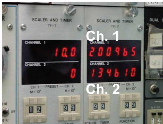
図 5.3.2 MK-III初臨界到達時の起動系核計装信号
