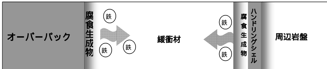
図 4 : オーバーパックおよびハンドリングシェル材料の腐食に伴い、緩衝材中に放出される鉄の概念図
