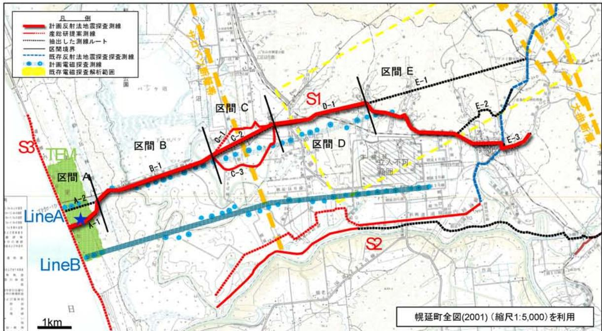
図 4-C (3)-4) 探査測線設定可能なルートを選定結果図
