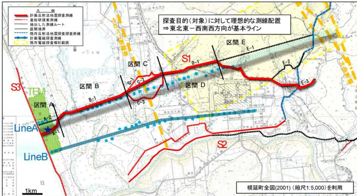
図 4-C (3)-2) 探査対象に対しての理想的な探査測線配置図
