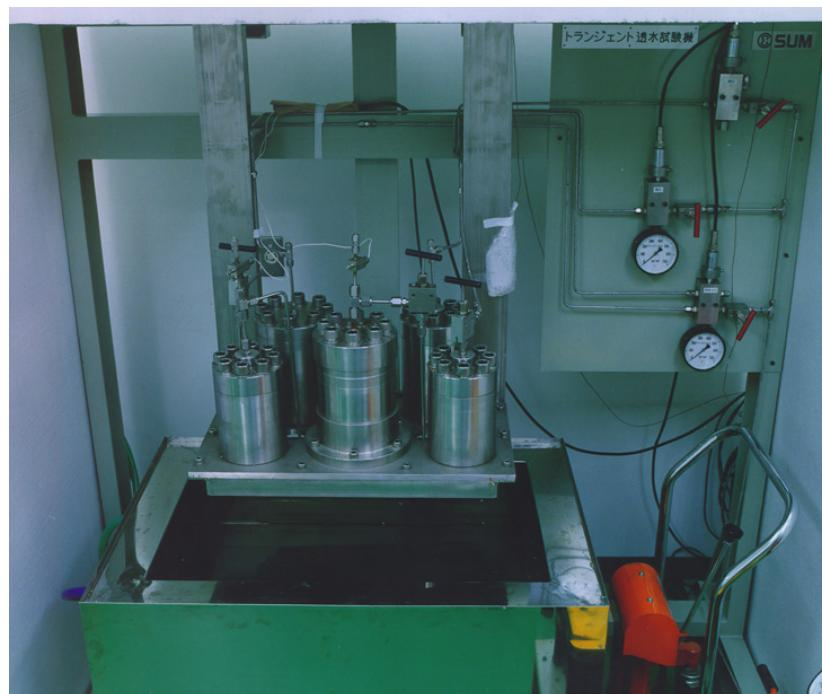
写真 3.3-1 トランジエントパルス透水試験装置概観
