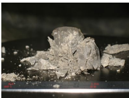
(e) 一軸圧縮試験終了後の様子
