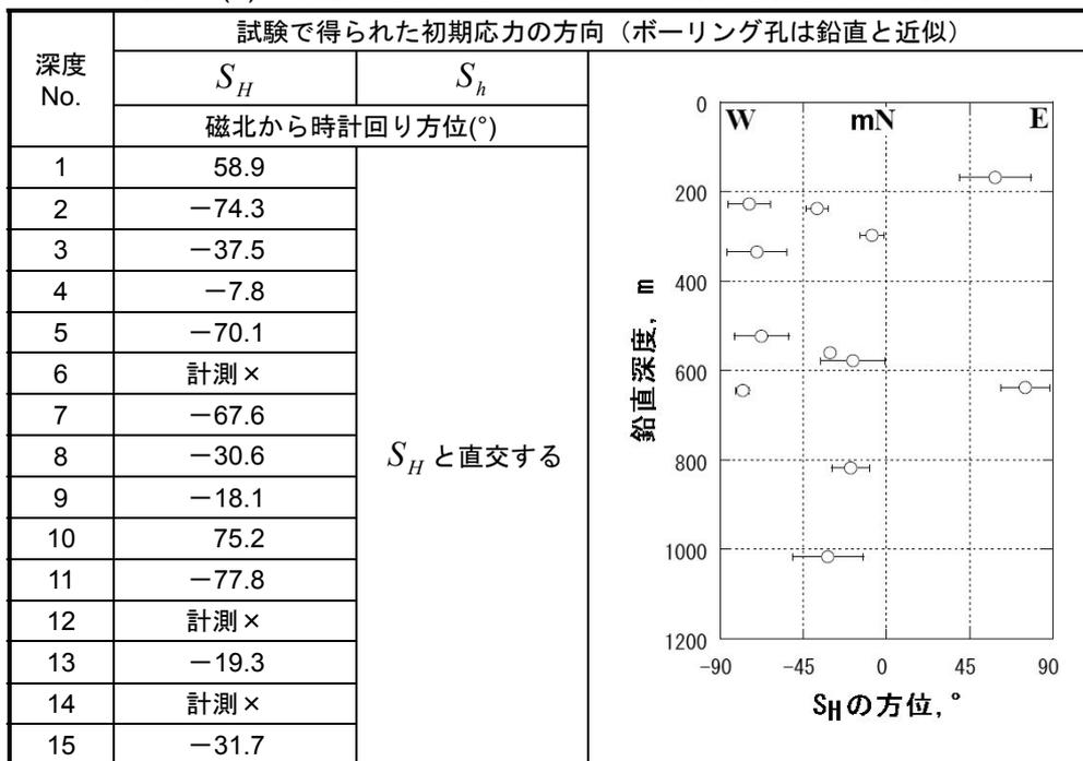
表 5.3(b) 水圧破砕法で求めた MIZ-1 号孔の初期応力値 (圧縮を正)
