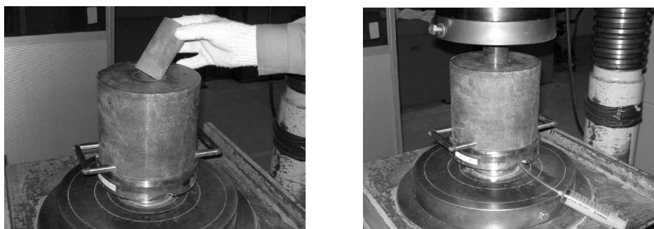
図 3. 1. 1-1 高圧抽出装置によるセメント硬化体からの間隙水の採取状況 (左図：硬化体のセッティング，右図：载荷及び間隙水の採取)
