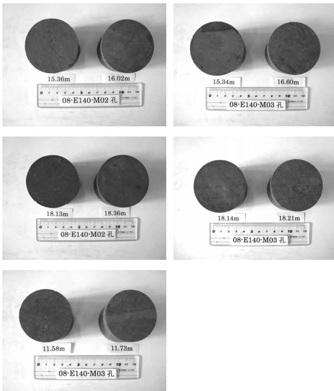
図 6.2 圧裂引張試験片(2/2)
