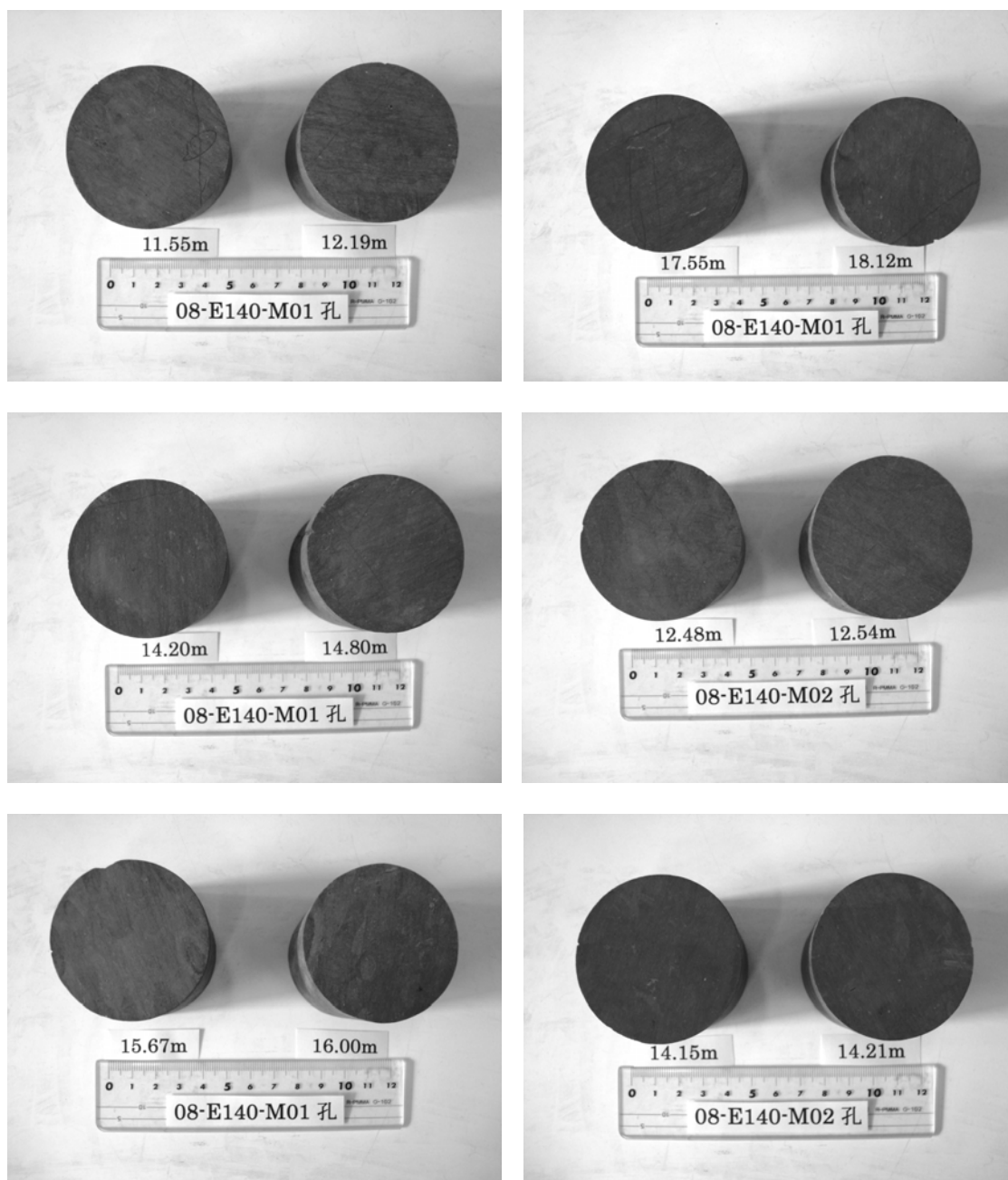
図 6.2 圧裂引張試験片(1/2)
