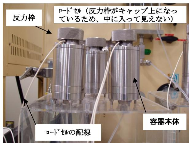
写真 3.2-2 直径 20mm 試験容器 (拘束型試験装置)
