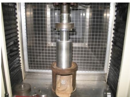
写真 3.2-12 圧縮成型後の供試体の押し出し
