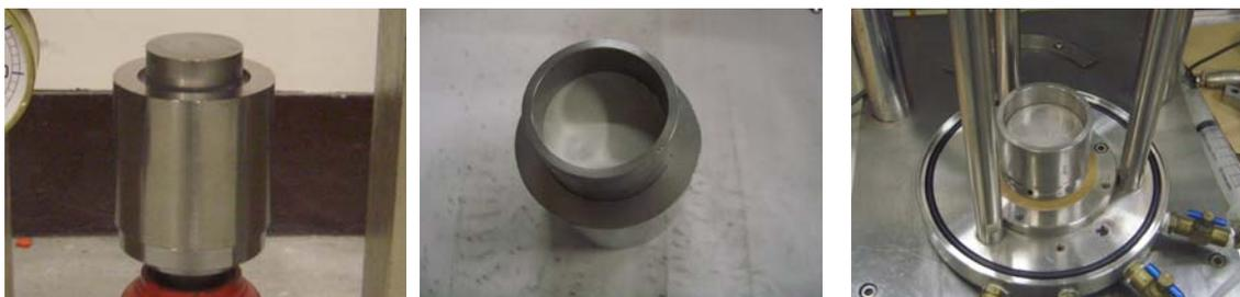
モーラー式 (上下面加圧 (ピストン、モーラー))      リングへスライドさせた供試体      試験装置へのリングの設置
