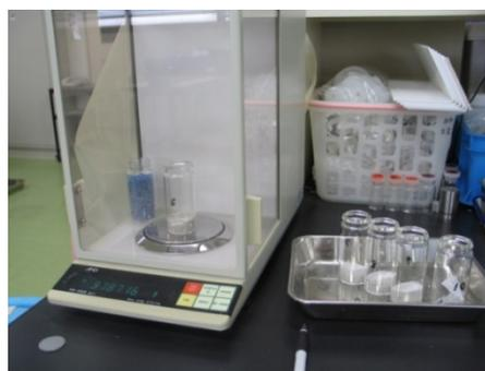
写真 3.2-15 切断供試体の重量測定
