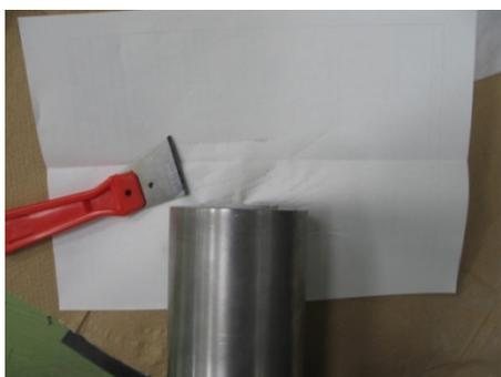
写真 3.2-14 供試体の切断状況 (2mm)
