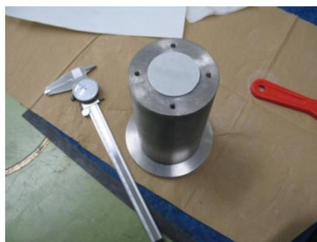
写真 3.2-13 供試体押し出し後の状況
