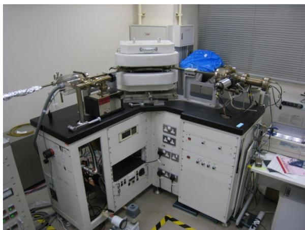
図 5.1-6 MM5400 型希ガス質量分析計
