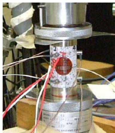
図 2.4 载荷試験中の試験片まわりの様子
