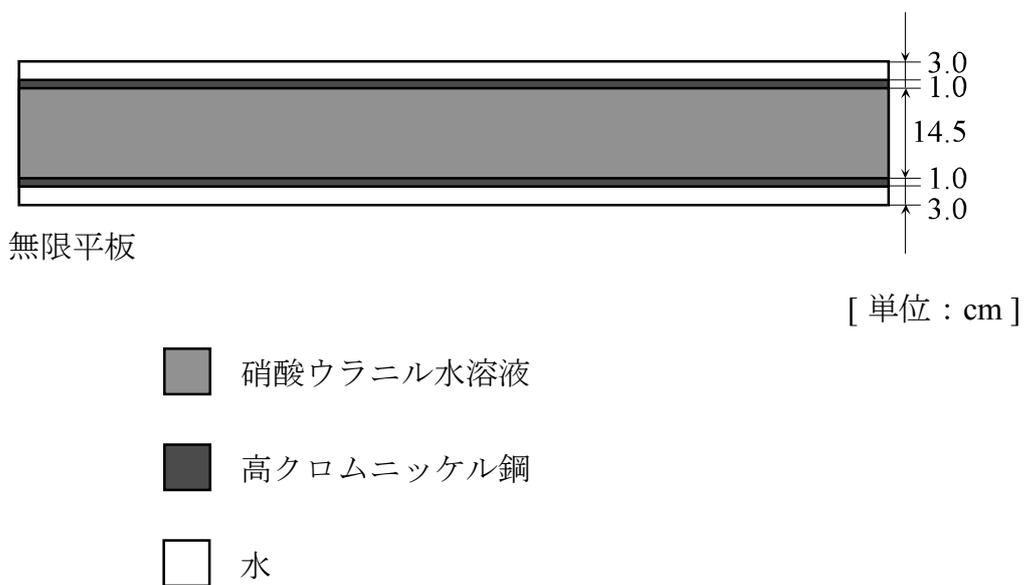
図 2.5 スラブ部最適濃度サーベイ計算モデル
