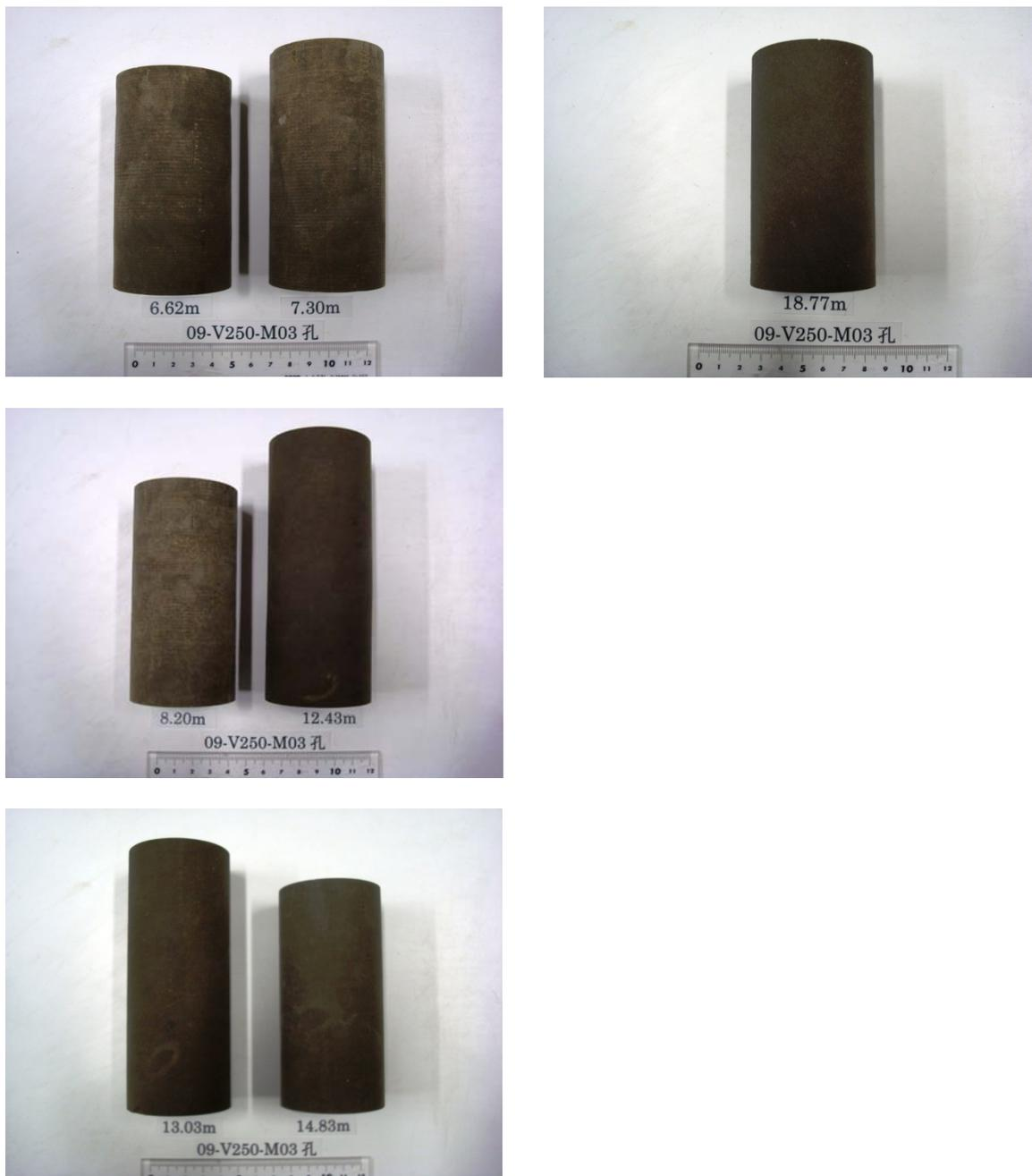
図 6.1 一軸圧縮試験片(2/2)
