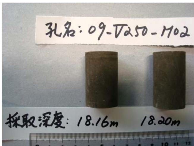
図 5.8 繰り返し载荷試験用の試験片
