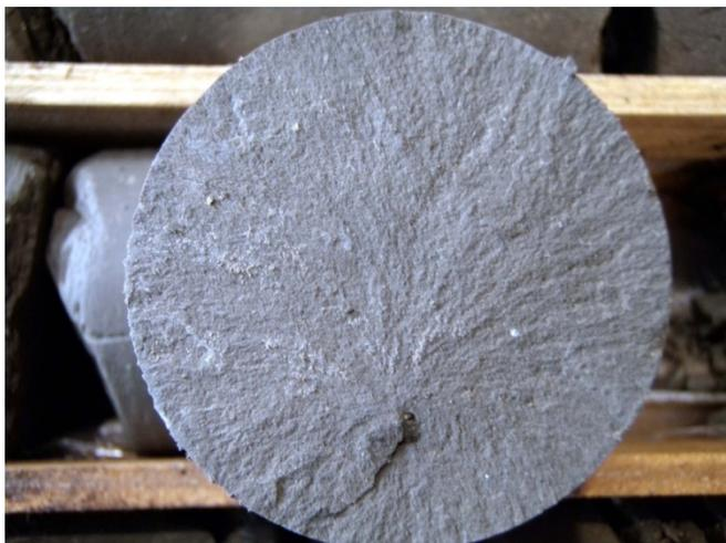
図 3.11 コアディスクング (09-V250-M01 孔、8.5m 付近)。
