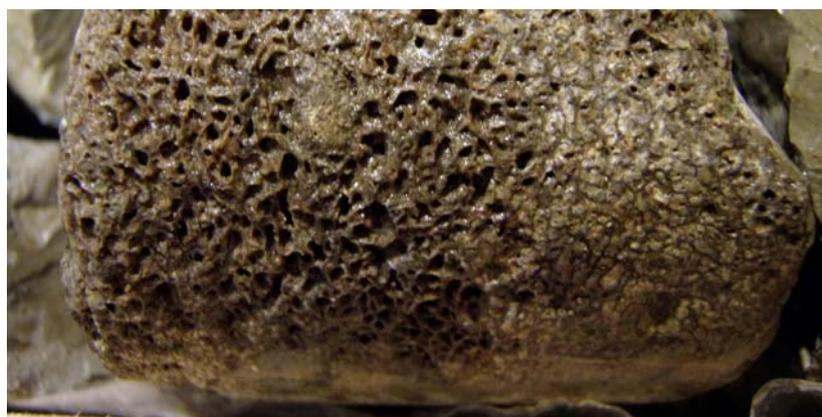
図 3.6 石灰質ノジュールに含まれる化石 (09-V250-M01 孔、深度 19.15m 付近)
