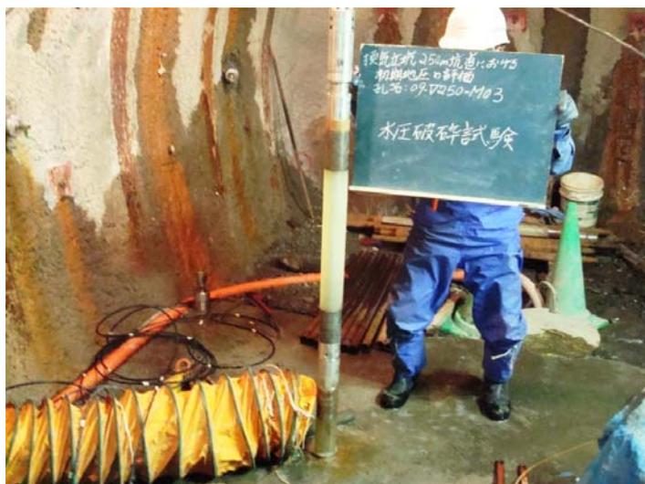
図 4.3 ストラドルパッカーの挿入
