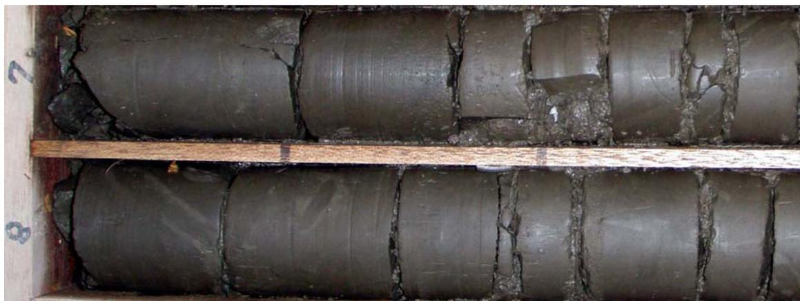
図 3.4 軟質な泥岩 (09-V250-M02 孔、深度 7m～深度 9m 付近)
