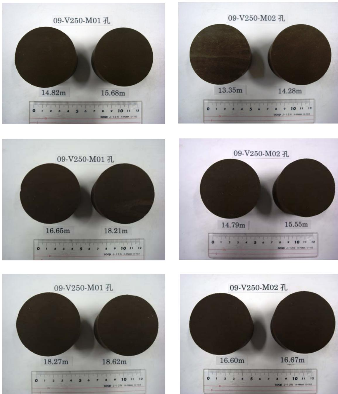
図 6.2 圧裂引張試験片(1/2)
