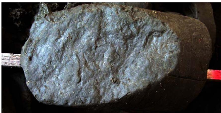
図 3.7 せん断割れ目（09-V250-M01 孔、8.5m 付近）
