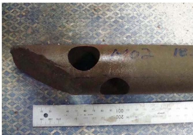
図 5.7 繰り返し载荷試験のための再コアリング
