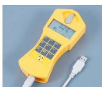
写真 2 線量率測定装置
