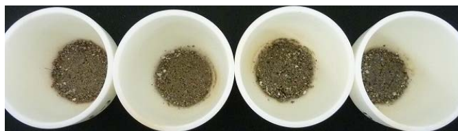
写真 3.2-4 1300 °C 加熱試料の外観 (左から 5, 10, 30, 60 分)
