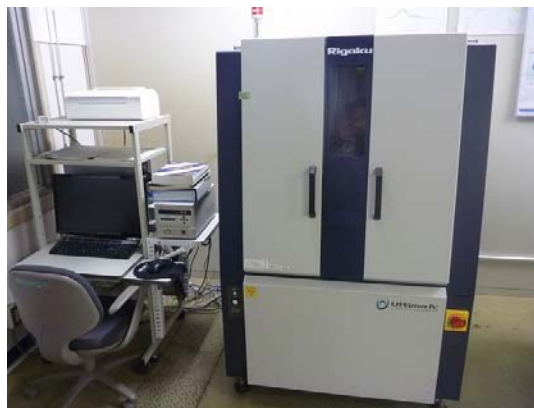
写真 3.1-5 XRD 測定装置の外観
