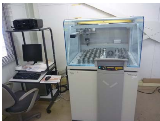
写真 3.5.2-1 XRF 装置の外観
