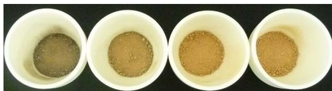
写真 3.2-1 600 °C 加熱試料の外観 (左から 5, 10, 30, 60 分)
