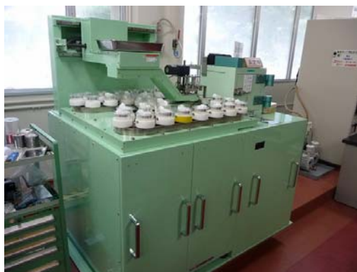
写真 3.1-2 サンプルチェンジャー付 Ge 半導体検出器の外観
