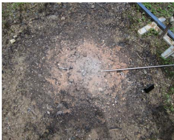
写真 2.2-1 土壌加熱後の土壌表面の状態 (例：坑水処理施設 褐色森林土)
