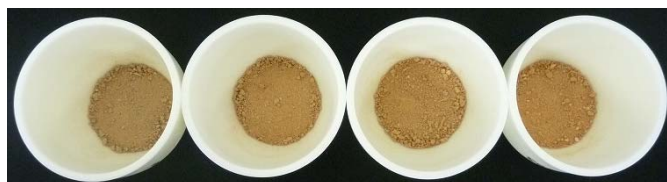
写真 3.2-2 800 °C 加熱試料の外観 (左から 5, 10, 30, 60 分)
