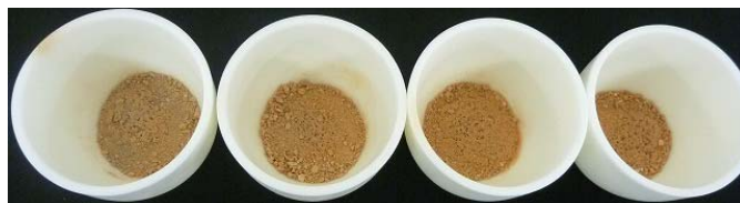
写真 3.2-3 1000 °C 加熱試料の外観 (左から 5, 10, 30, 60 分)
