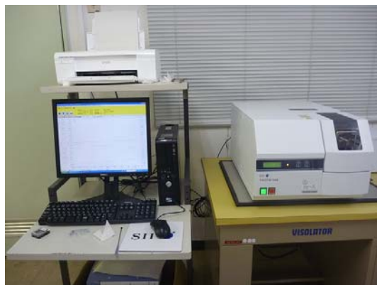
写真 3.1-6 TG/DTA 装置の外観
