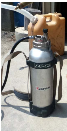
写真 1 給油・加圧タンク
